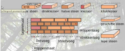
Benamingen van het metselwerk
